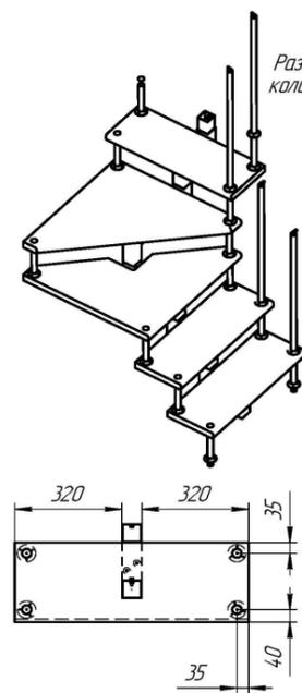
Разметка сверления поручня под крепление к стойкам перил (глухое отверстие  $\varnothing 7 \times 30$  мм) количество отверстий и общая длина поручня – в зависимости от конфигурации лестницы
