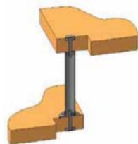
7. Еще одним элементом увеличения жесткости конструкции лестницы является использование больц. Под них необходимо будет просверлить отверстия 8 мм.
